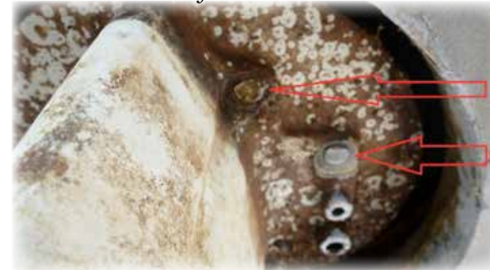
Insgesamt 5 abgerissene Schraubenköpfe am Schaft des Saildrive
