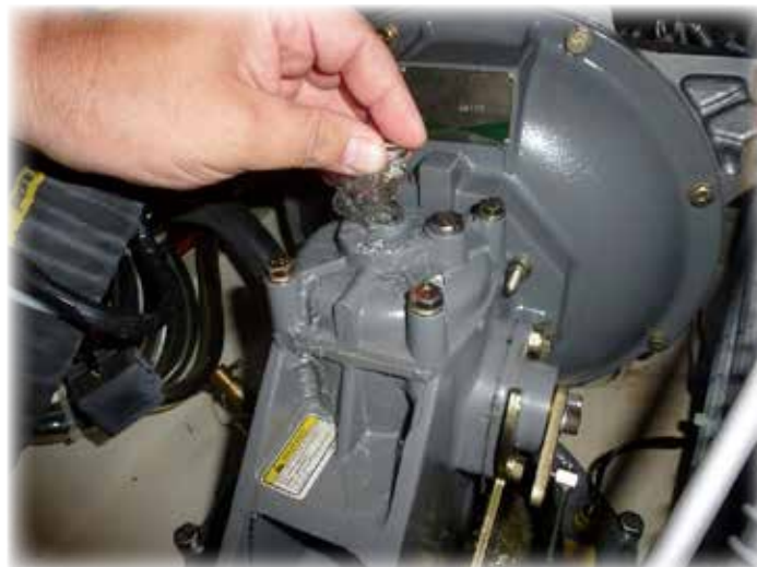
Wassereintritt aus Öleinfüllschraube
