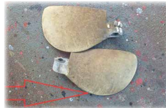
Anschlagstelle im Propeller
